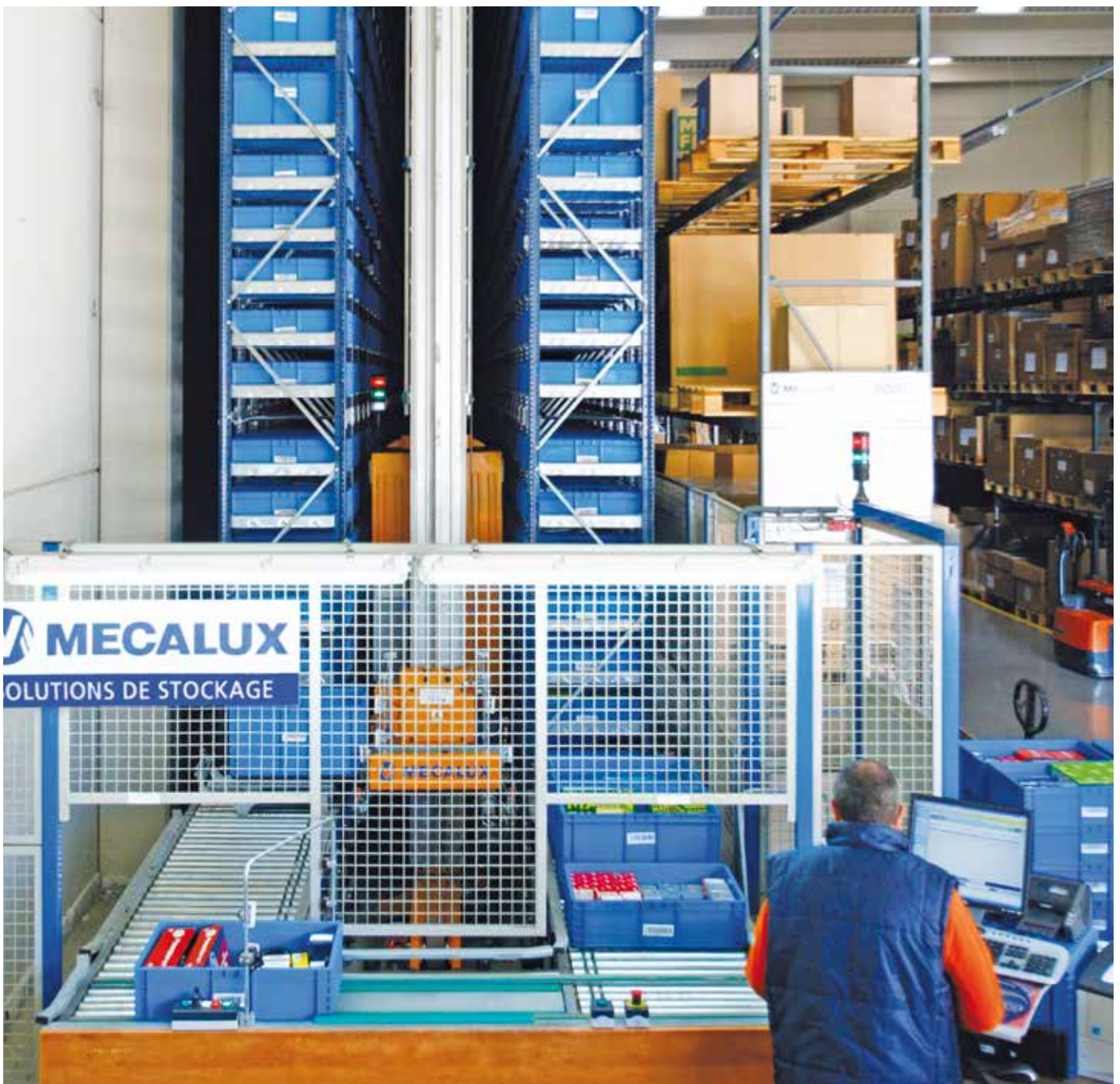
Vue détaillée d'un poste de picking frontal avec une seule console de tête et une double allée d'extraction
