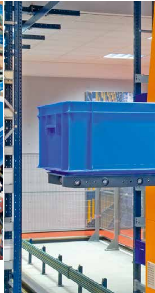
Extracteur à pelles permettant d'extraire deux caisses simultanément.
