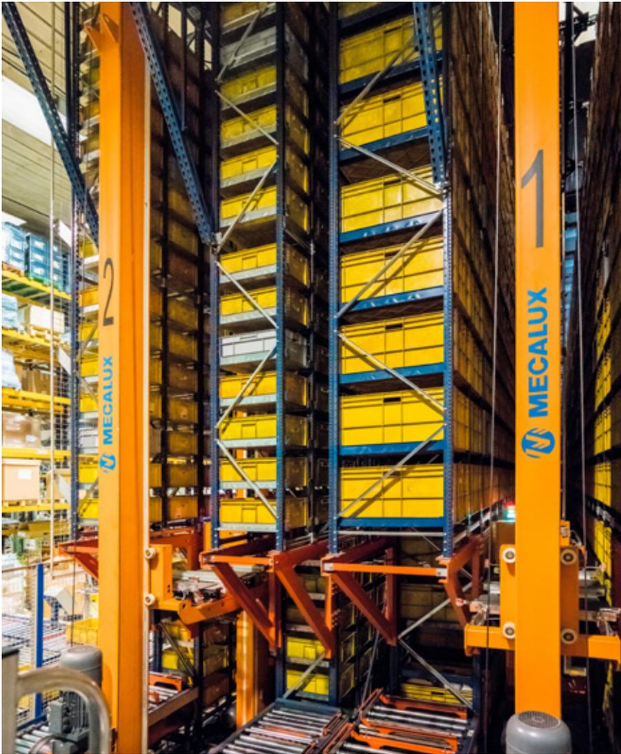
Dans chacune des allées, circule un transstockeur à double colonne, dont la mission est d'effectuer automatiquement les entrées et les sorties de la marchandise. Ces machines travaillent à une vitesse de translation de 250 m/min et 90 m/min en levage.
