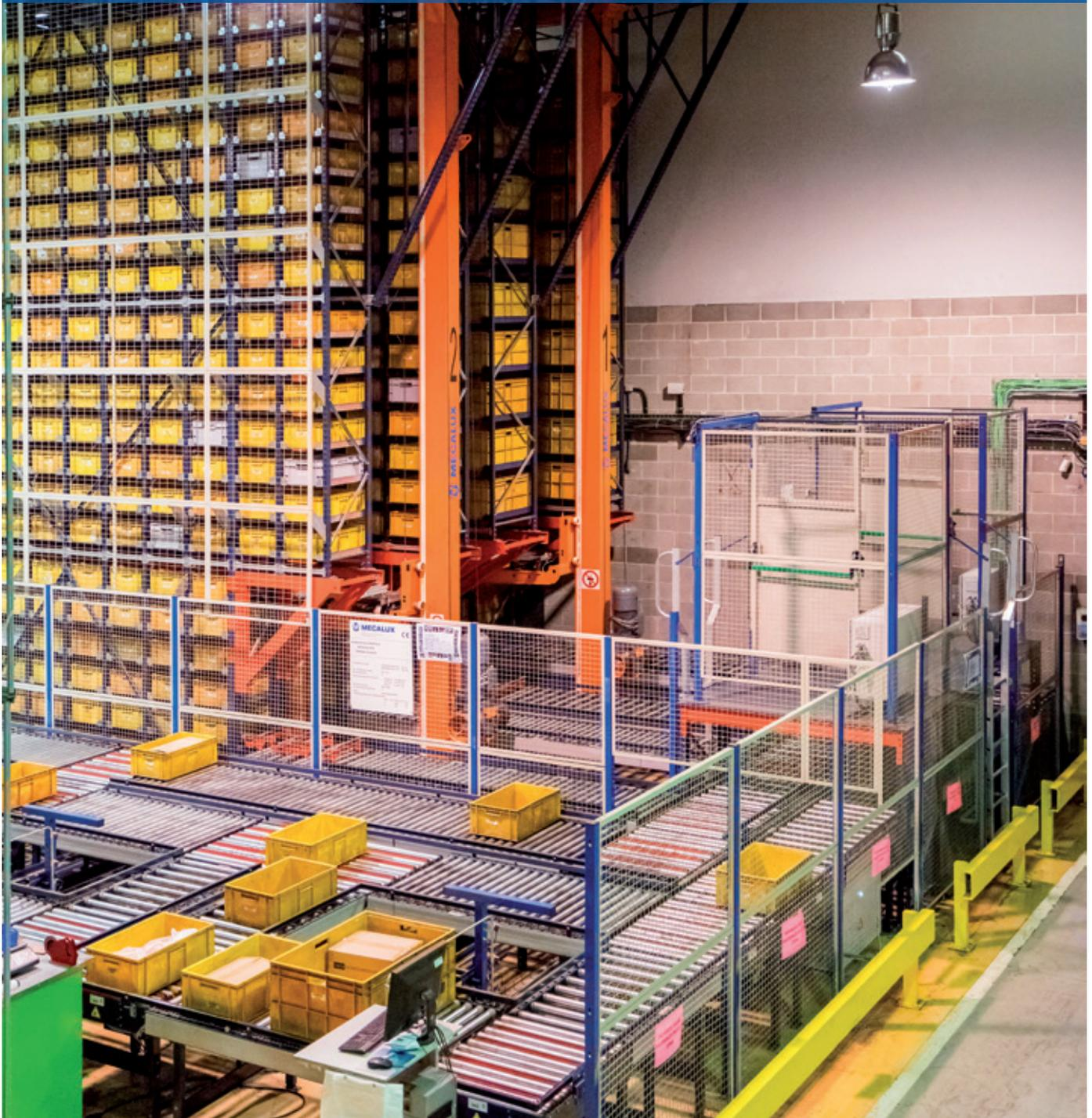
Mecalux a équipé l'entrepôt de JCH, situé à Barcelone, d'un magasin automatique miniload offrant une capacité de stockage de 4 076 caisses. Elle a également installé un circuit de convoyeurs et trois postes de picking opérant l'un à la suite de l'autre. L'installation comprend le logiciel d'entrepôt Easy WMS. Ce dernier garantit la performance maximale lors de la préparation de commandes.
