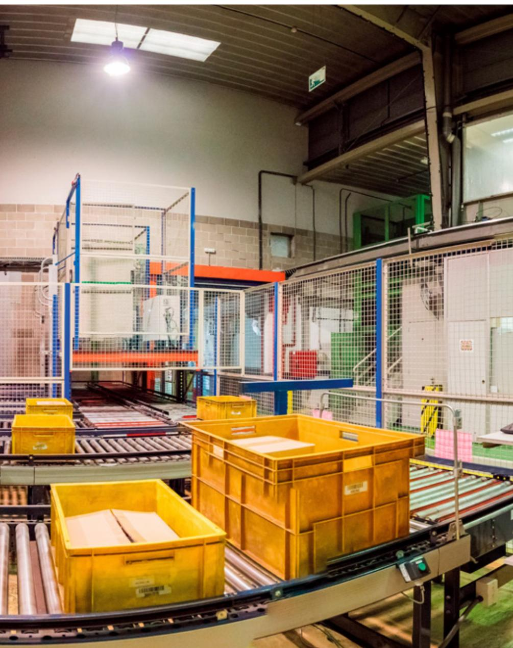
Le magasin miniload exploite au maximum la surface disponible pour maximiser la capacité de stockage, en plus d'être un système automatique qui facilite le picking
