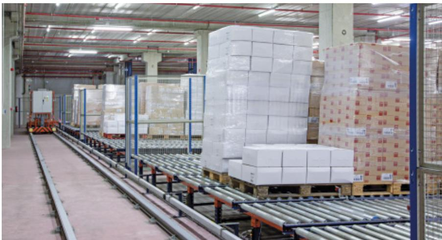
se démarquent par leur capacité d'adaptation à tout type de charge, de poids et de volume. Quant aux rayonnages par accumulation, ils peuvent contenir jusqu'à dix palettes successives.
