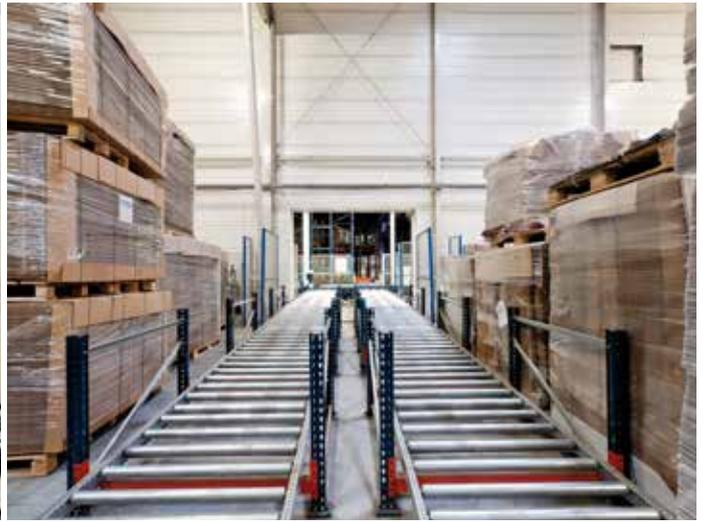
Deux canaux dynamiques assurent la sortie des palettes et permettent aux opérateurs de les retirer directement par l'extrémité inférieure
