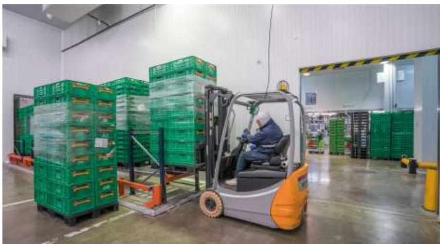
En ajoutant principalement des solutions par accumulation, Mecalux a optimisé le volume de l'entrepôt pour obtenir une capacité de stockage de 1 531 palettes de 800 x 1 200 x 2 350 mm
