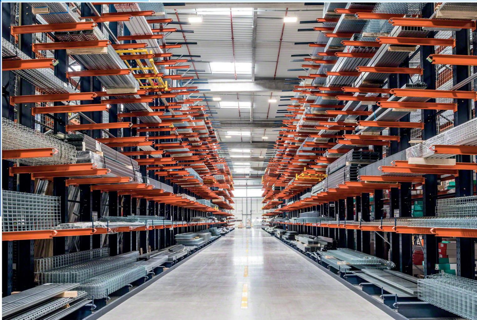
Ils se composent fondamentalement de colonnes, formées d'un profil vertical et d'un ou de deux profils horizontaux posés sur leur base pour leur donner de la stabilité. Sur ces colonnes, une série de bras est fixée en porte-à-faux pour y déposer la charge.
