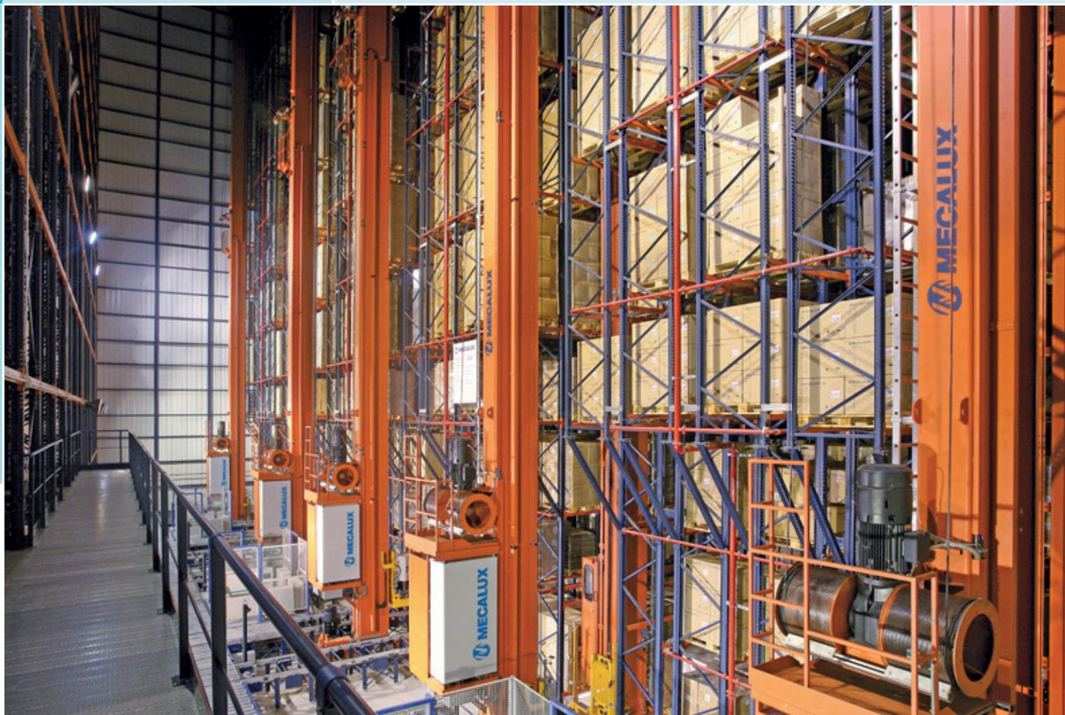
Les transstockeurs sont des machines créées pour le stockage automatique de matériel moyennant des mouvements mécaniques automatisés. Les entrées et les sorties de marchandises sont exécutées en un seul et même mouvement (cycle combiné), permettant ainsi d'augmenter la productivité des installations tout en réduisant les ressources nécessaires à leur fonctionnement.
